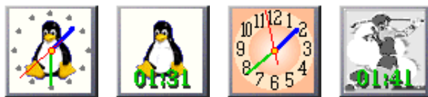
図 8 XawXPM ライブラリを使った Xawclock . マウスクリックでアナログ(左端)とデジタル(左から 2 番目)に移り変わります
