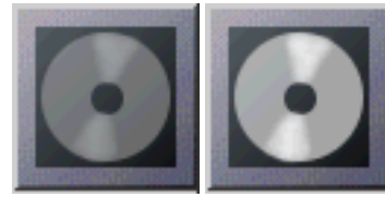
図 7 After Step 用に設計された asmount : 一つのデバイスしか制御できません . マウントされるとディスクが明るくなります ( 右 )
