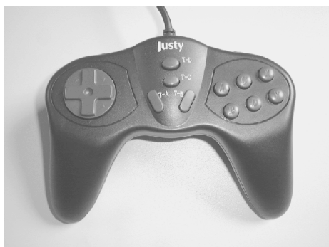
図 1 トライコーポレーション社製の安価な 2 軸 8 ボタンのジョイパッド Justy JPD-108 : 中央は連射ボタン, 向こう側には L,R ボタンも付いています。
